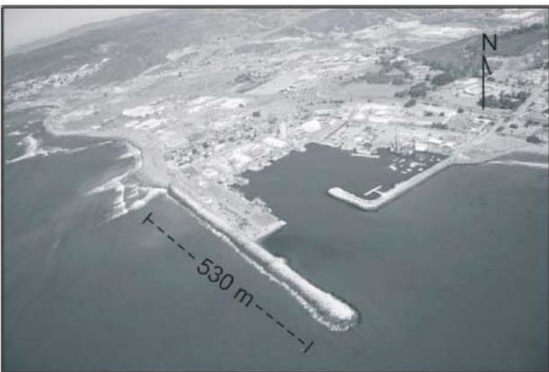
**Figura 3. Puerto El Sauzal, Baja California, donde se ilustra una configuración adecuada entre la escollera principal y la escollera secundaria. Imagen cortesía de Servicios Portuarios S.A. de C.V., junio, 2003.**
