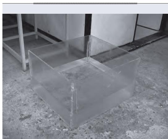
Figura 6. Depósito para medición de las descargas de rebase.
